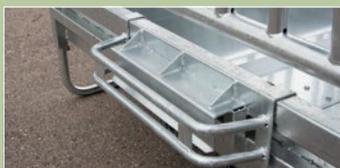
Dreipunkthängung (mit Schutzbügel)
